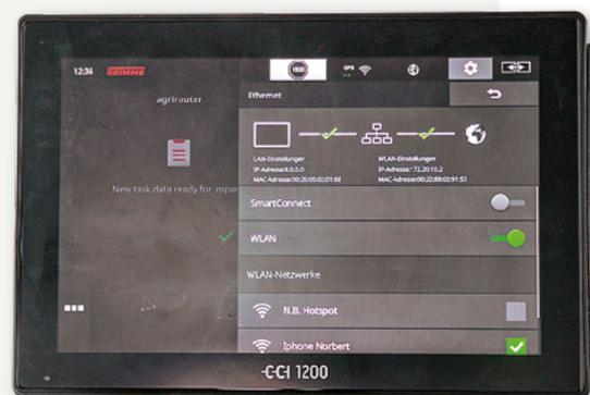
Zur Eingabe eines im Agrirouter erzeugten Registrierungscode muss das CCI-Terminal per WLAN mit dem Internet verbunden werden.
